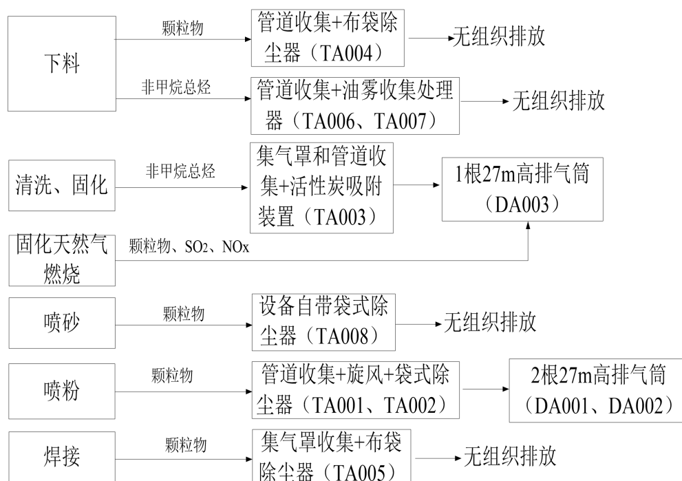
图 4-1 项目废气污染治理措施工艺流程图
