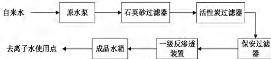
图 2.10-4 去离子水制备流程图
