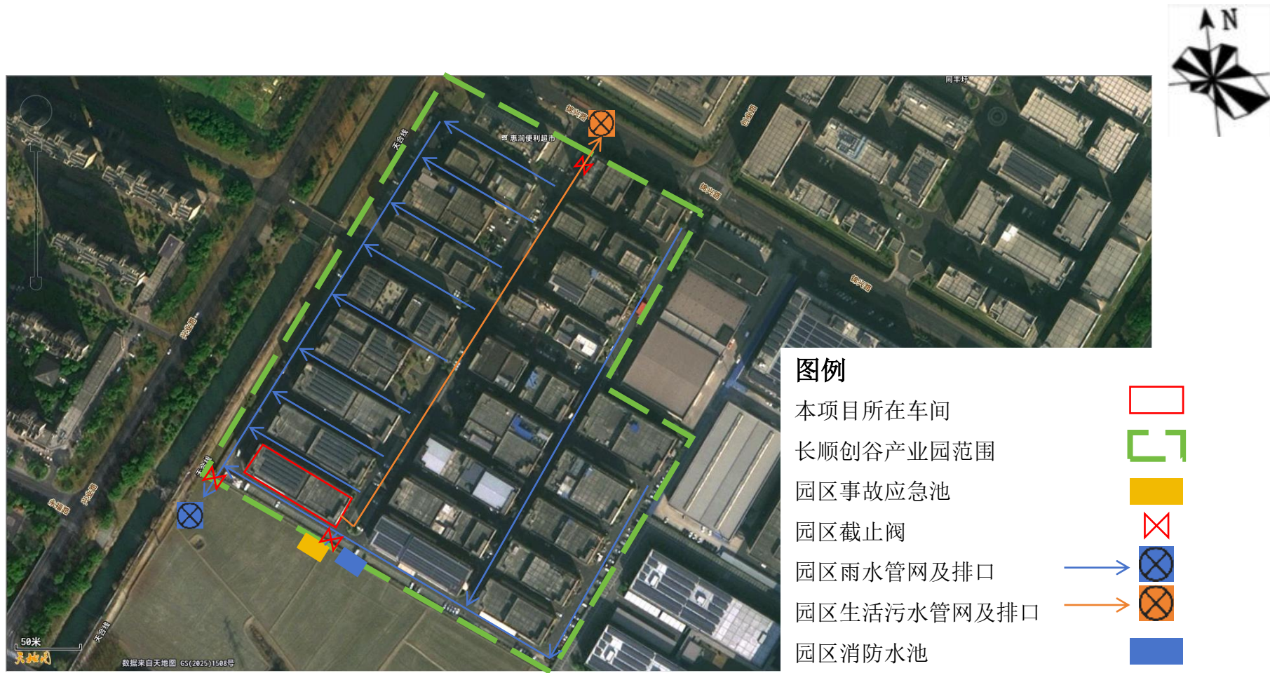
附图2 本项目与长顺创谷产业园环保设施及管网位置关系图
