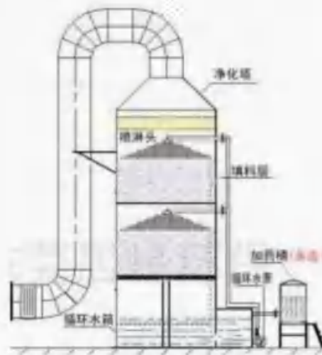
图 4-2 碱液喷淋装置示意图
