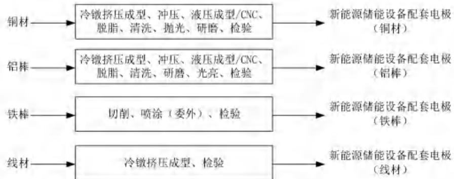
图 2-4 项目整体产品简要生产工艺流程汇总图
