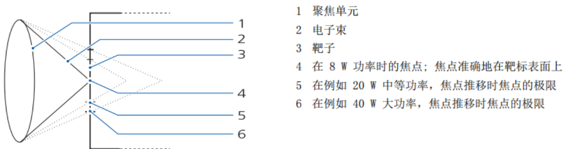
图11-2ZEISS METROTOM 800型工业计算机断层扫描（CT）电子束与探测器示意图
