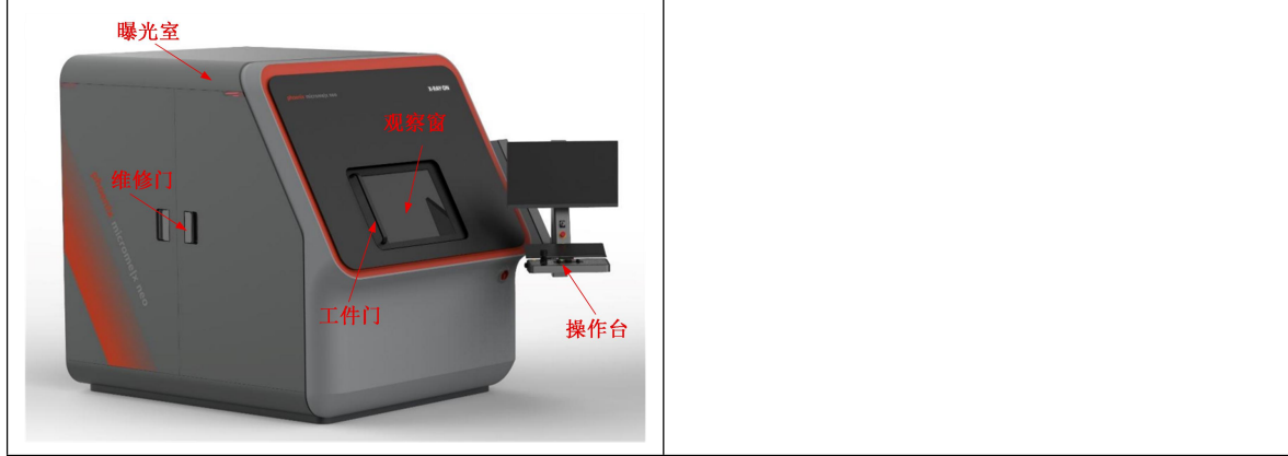
图 9-1 本项目工业 CT 装置样式及内部结构图
