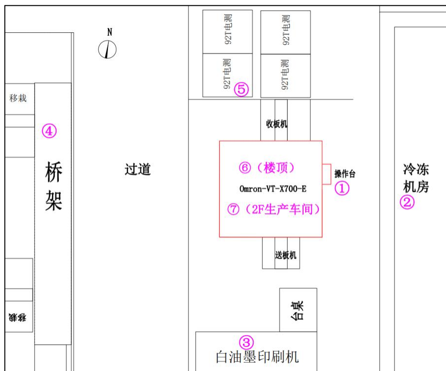
图 11-1 Omron-VT-X700-E 型工业用 X 射线 CT 装置周围关注点示意图
