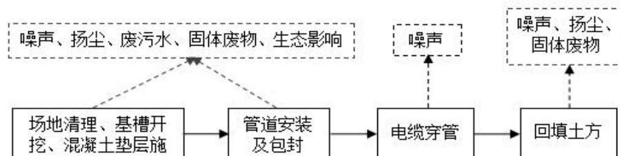
图 2.2 本项目电缆施工工艺流程示意图
