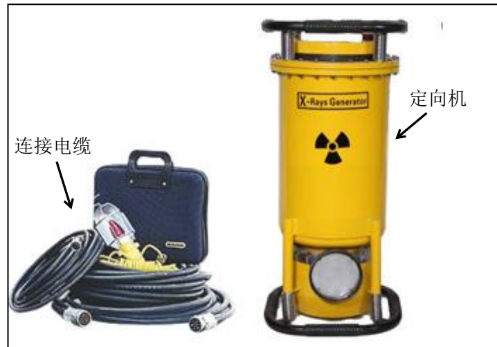
图 9-2 设备厂家 X 射线探伤机外观图及连接电缆
