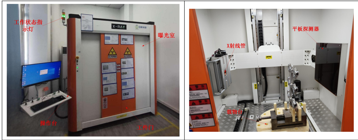
图 9-1 本项目 X 射线实时成像检测装置样式及内部结构图
